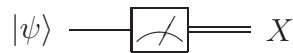
Figura 2.3: Representação de medida: estado quântico |\psi\rangle é convertido em um estado clássico X
