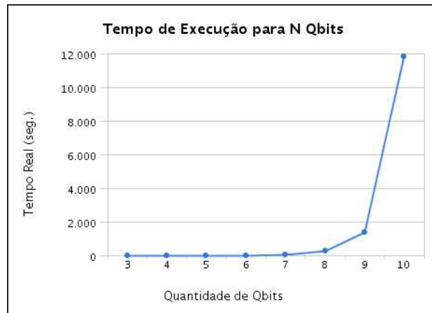
Figura 6.1: Tempo de execução da simulação para N Qbits, com t = 10000 repetições do experimento.
